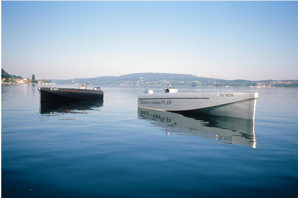
Das als Arbeitsgondel konzipierte Boot Tender 06 mit dem mittigen Steuerstand überzeugt auch als Freizeit- oder Beiboot von Luxusyachten. Der Rumpf aus Komposit wird mit einer Holzbeplankung kombiniert. Der Riss, der eine aquadynamisch günstige lange Wasserlinie garantiert, lässt das wendige und leichte Boot sehr ruhig fahren. Die Jury hebt neben der gelungenen Synthese von bootsbauerischen und gestalterischen Qualitäten besonders hervor, dass mit Tender 06 ein neuer Bootstyp entworfen wurde.
