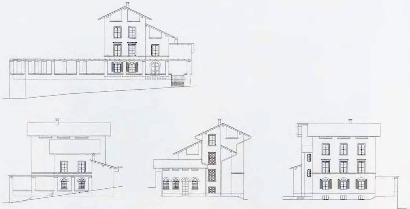
[a-d] Jürg Ragetti. Rekonstruktion der ursprünglichen Fassaden nach Bauaufnahme. 1999
