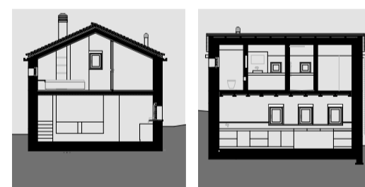
Querschnitt und Längsschnitt des Hauses: Unten der Eingang sowie der Koch- und Essbereich, oben Schlafzimmer, Bad und Ankleide.
